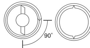
工具がインサートに引っかからない場合は、ヤスリで図右側の様にキズを付けてください。
