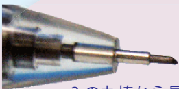
\phi 3 の丸棒から長方形のフライス加工品
